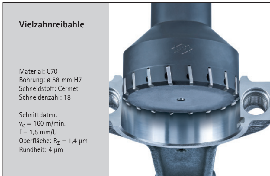
Bild 6: Vielzahnreibahle zur Erhöhung der Produktivität und der Energieeffizienz.
